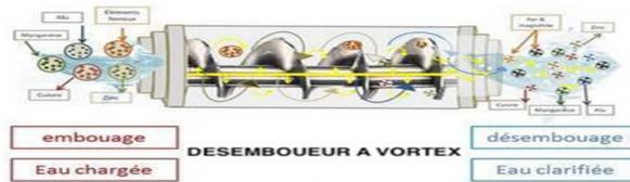
L'embouage est le fléau de tout circuit fermé de chauffage ou de climatisation car il nuit au bon écoulement de l'eau créant dysfonctionnements, casse de chaudière... Il est dû à la corrosion et au développement bactérien, inévitables s'il n'y a pas un traitement permanent très efficace.
