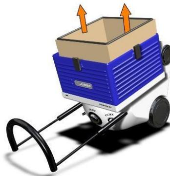
2. Insérer une nouvelle cassette filtrante. Veiller à ne pas endommager le joint sur le dessous de la cassette filtrante.
