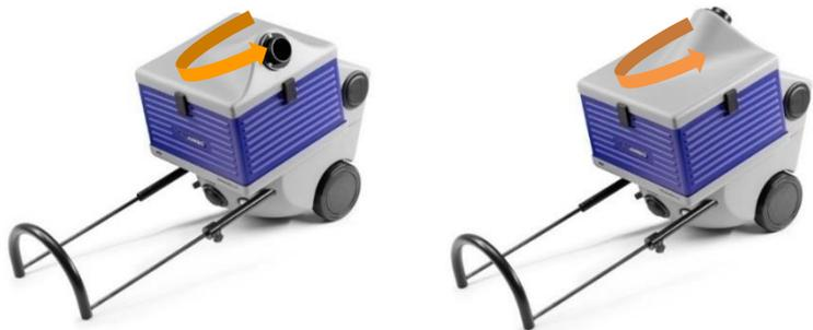
Mettre le JUMBO Filterrolley en place en fonction de l'emplacement de travail. Pour collecter les substances nocives en toute sécurité, l'élément de prélèvement doit être positionné tout près du lieu d'émission des substances nocives. Si l'élément de prélèvement ne se trouve pas directement sur l'appareil, il doit être raccordé au moyen d'un tuyau court.
