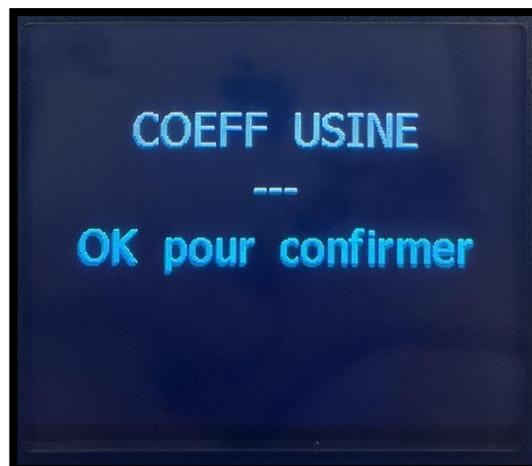
Pour valider l'envoi des coefficients usine dans le capteur valider avec la touche OK puis appuyer sur Escape (ESC) pour revenir à l'écran précédant.
