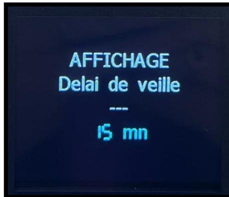
Par défaut le délai avant activation du standby est de 2 minutes et il peut être paramétré selon les timings suivants : 2, 5, 15 ou 30 minutes.
