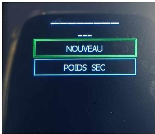
Pour accéder au menu d'étalonnage du paramètre Turbidité en mg/L sélectionnez le menu NOUVEAU.
