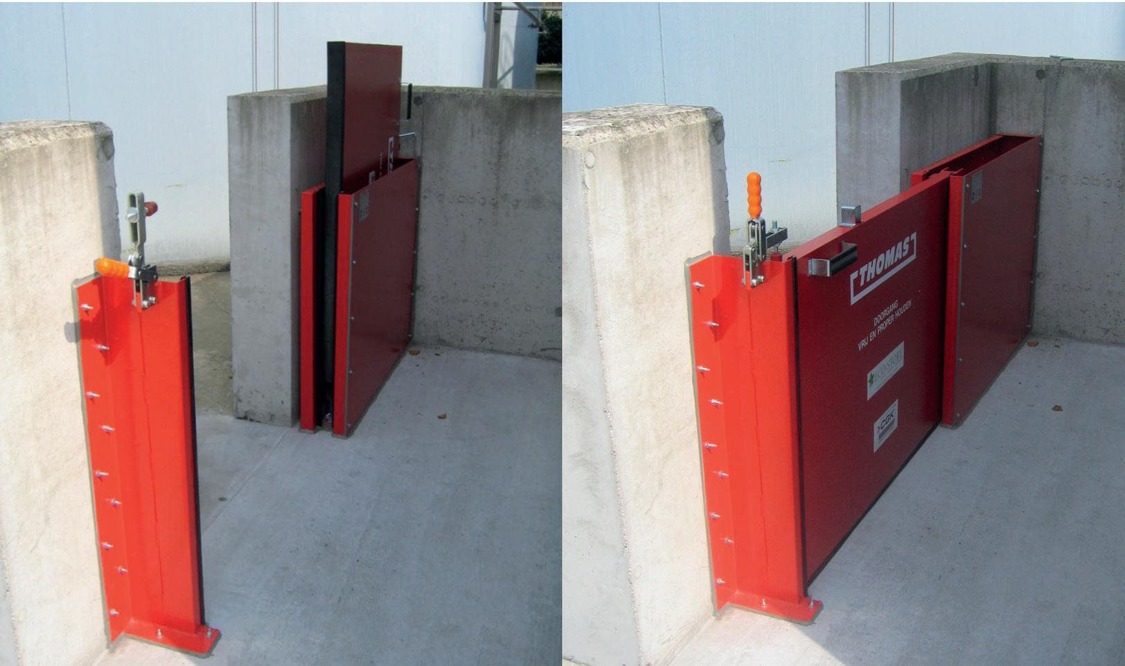
Cette barrière de rétention manuelle certifiée TUV et VdS se compose d'un côté de l'ouverture par une barrière (hauteur et longueur à déterminer) reposant sur un socle et de l'autre côté d'un profilé U.
