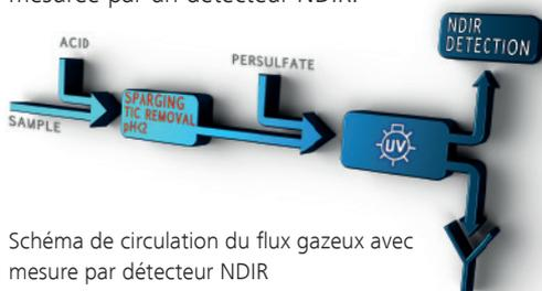
Schéma de circulation du flux gazeux avec mesure par détecteur NDIR
